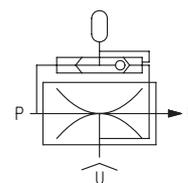
P=CONNESSIONE ARIA COMPRESSA      R=SCARICO      U=CONNESSIONE VUOTO
